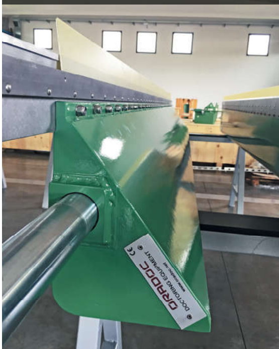
Particolare del sistema di raschiatura OraClean K35.
